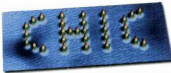
Manipulierte Cu-Atome auf einer Fläche von 25 \times 8 \text{ nm}^2 . IBM.
